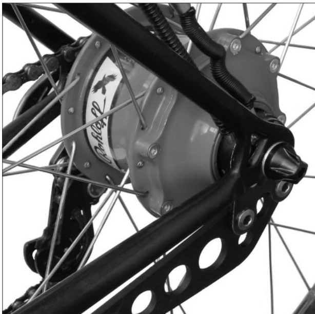
Rohloff SPEEDHUB 500/14 CC met lange draaimomentsteun
